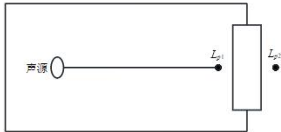
图 4-1 室内声源等效为室外声源示意图
