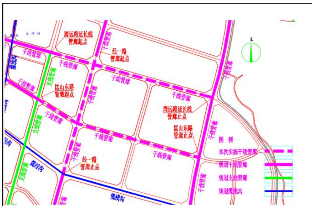
图2.4.5项目综合管廊布设平面图
